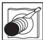
Lisser le joint. Utiliser soit un produit de nettoyage dilué, soit un agent lissant, avec une spatule étroite.
