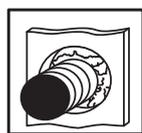
Insérer si besoin le matériau de remplissage : S'assurer que le matériau de remplissage est appliqué et compressé conformément à l'agrément technique européen (voir tableaux pages suivantes).
