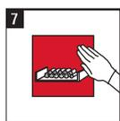
Après 5 minutes environ (à 23 °C), la mousse est ductile et peut être modelée. Porter des gants de protection !
