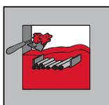
Placer un coffrage sur l'un ou les deux côtés de grandes ouvertures. Les ouvertures en dalle doivent avoir un coffrage en dessous. Appliquer le mortier mélangé dans l'ouverture à l'aide d'une truelle ou d'une pompe et le compacter. Veiller à ce que tous les trous et les espaces soient complètement remplis et fermés. Lisser la surface comme un béton standard.
