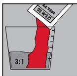
Ajouter le mortier coupe-feu Hilti CFS-M RG à l'eau dans un ratio d'environ 3:1 (mortier/eau en poids). Ce ratio de mélange détermine la consistance (rigidité), recommandé 2½ :1 pour une application à la main à un maximum 3½:1 pour une application à la pompe.
