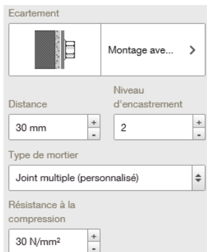
Figure 19 : Sélection d'un écartement avec couche intermédiaire
