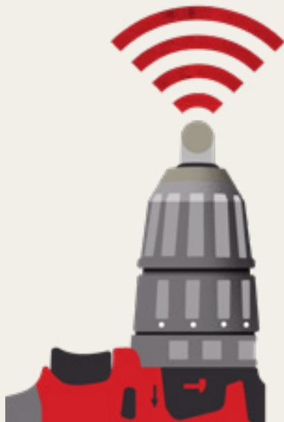
**Outil connecté** – Outil équipé de technologies (ex. : puces, logiciels et capteurs) destinées à collecter des données concernant l'outil et à le connecter à un système pour remonter les informations.
