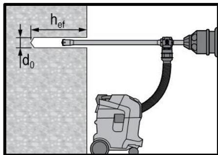
Trou percé au parforateur avec une mèche creuse (HDB)
