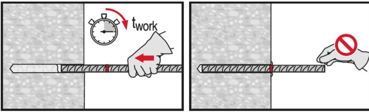
**Élément de réglage**, respecter le temps de travail " $t_{work}$ ".
