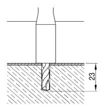
Pré-percer la tôle et le béton avec une mèche TX C5/23. Perforateur préconisé TE 6 à TE 16
