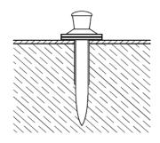
Fixation terminée. Valider la fixation en vérifiant le dépassement de la tête
