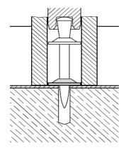
Insérer le clou dans le cloueur en plaçant la pointe de la fixation dans le trou pour obtenir un bon centrage et déclencher le tir
